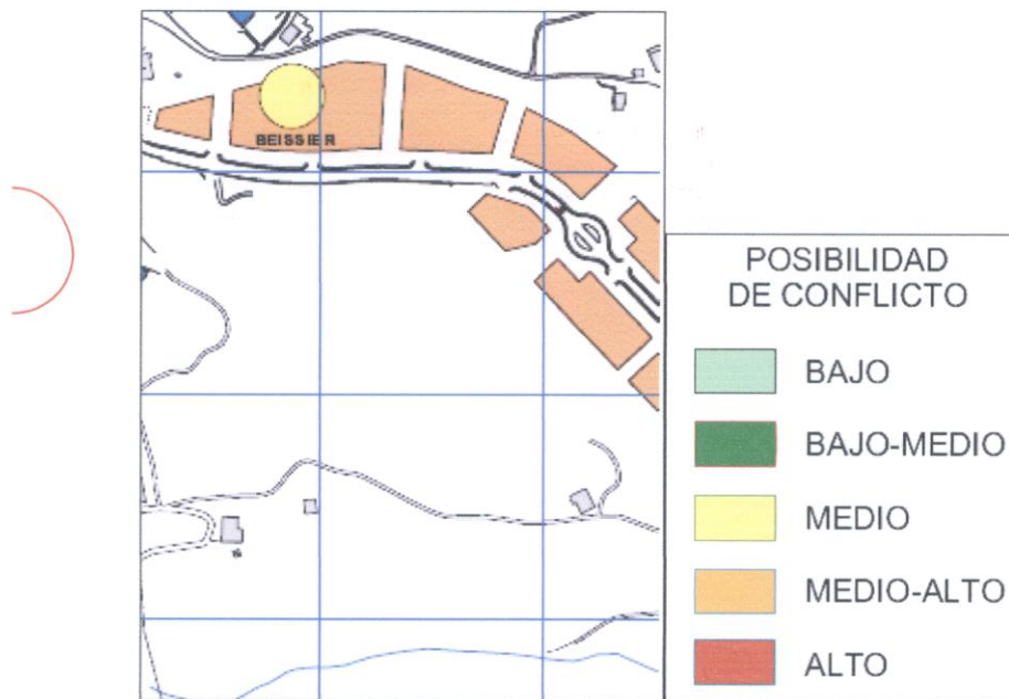
Figura 8: Posibilidad de conflicto acústico por ruido industrial
