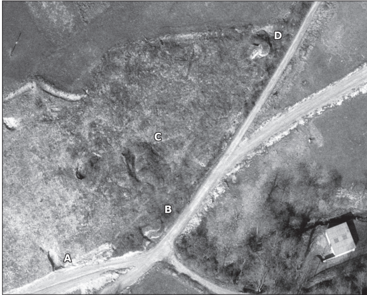
Fig. 52: Obra 26. Fotografía aérea (vuelo de 1975). Están señalados con letras los nidos y refugios, así como el inicio del acceso inconcluso a la obra. Los dos nidos se ven claramente por no estar camuflados con tierra. El camino es el acceso al campamento de Ingenieros de San Maximiliano (o Mokozorrotz). Se observan las obras del nuevo camino (actual en servicio) que se hizo con motivo de las obras de la Autopista.
