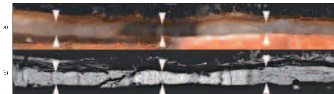
Figura 29. Estratigrafía de la lámina de estaño (entre flechas) perteneciente al retablo de Bidaurreta que llega a alcanzar las 10 micras de espesor: a) en luz normal se aprecia el estado de oxidación del metal donde el color gris parece indicar la presencia de óxido estannoso y el color blanquecino la de óxido estánnico, sin un aumento significativo de volumen (el grosor máximo detectado es 10\mu\text{m} ); b) en el Microscopio Electrónico de Barrido (MEB) se advierte con más detalle la estructura alterada de la lámina de estaño y también se puede ver que la zona gris oscuro en luz normal aparece más clara en el MEB (parte central de ambas imágenes) que las zonas blanquecinas las cuales en el MEB se muestran más oscuras (partes laterales de ambas imágenes).
