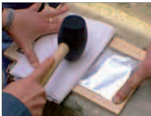
Figura 9. Impresión de la matriz en la lámina de estaño (esta última aparece recubriendo la matriz). Se utiliza un mazo de goma y como material amortiguador papel tissue plegado. Práctica realizada en 2003, San Sebastián.
