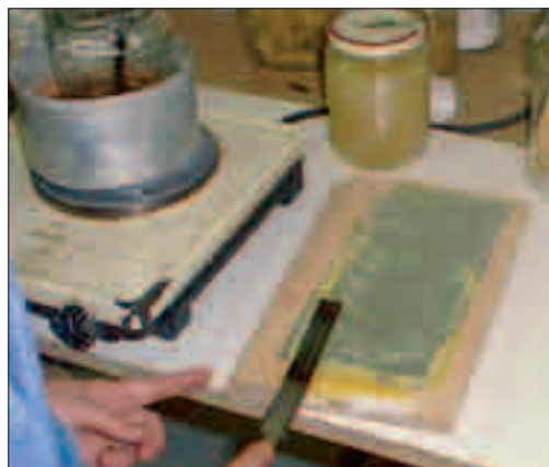
Figura 11. Aplicación en caliente de una masa de relleno de cera-resina sobre el estampado en negativo de la lámina de estaño. Práctica realizada en 2003, San Sebastián.
