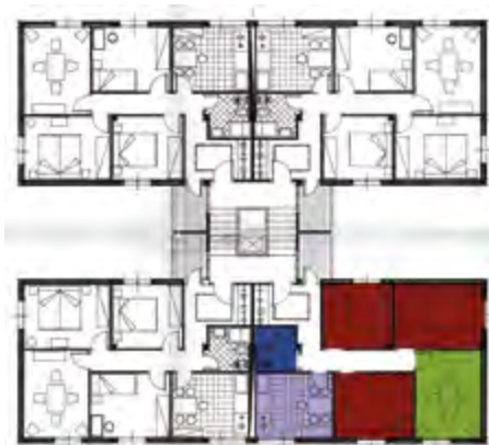
69 irudia . Galtzarabordako dorreen solairu-tipoaren oin-planoa. Iturria: Errenteriako Udal Artxiboa.
