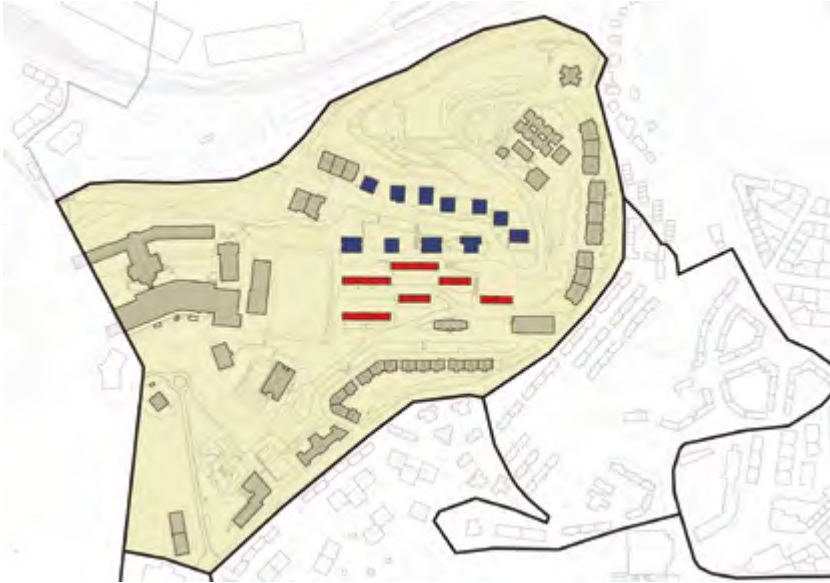
52. irudia. Kaputxinoetako etxebizitza tipologia errepikakorrenak adierazten dituen planoak. Gorriz bloke linealak eta urdinez dorreak. Iturria: egileek egina.
