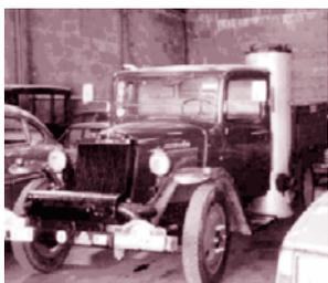
Camión equipado con gasógeno
