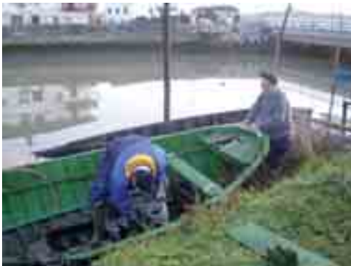
Achique de agua para aligerar peso a la hora de subir la motora en el camión-grúa.
