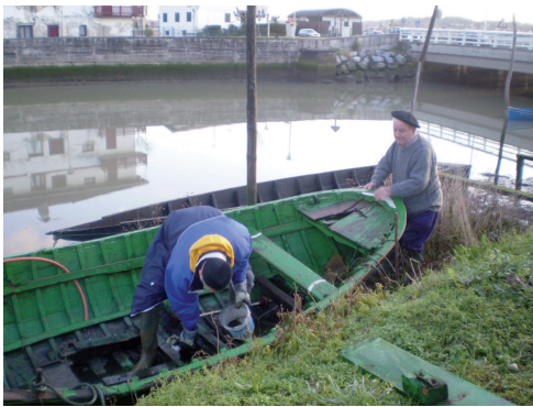
Achique de agua para aligerar peso a la hora de subir la motora en el camión-grúa.
