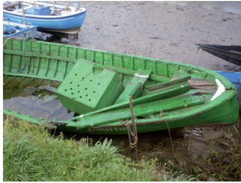
Estado de la popa, con la bancada partida y el cajón de motor desprendido.
