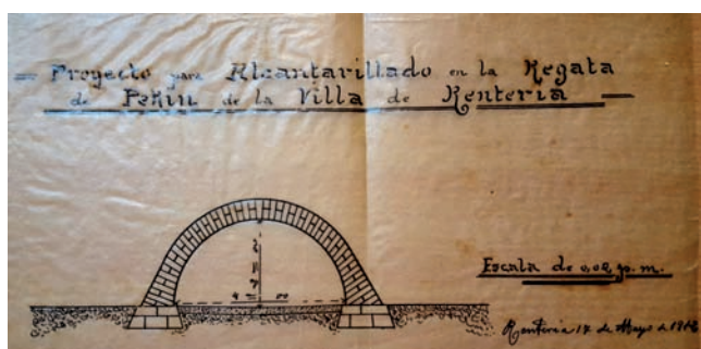
17 mayo 1912 proyecto de alcantarillado en la regata de Pekin. (AME: D-6-2-2).
