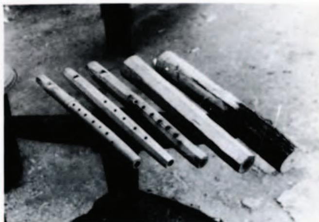
Fotografía n.º 2.— CHIFLOS en proceso de construcción por el artesano D. Paulino Rosa - Pipaón (Alava).
