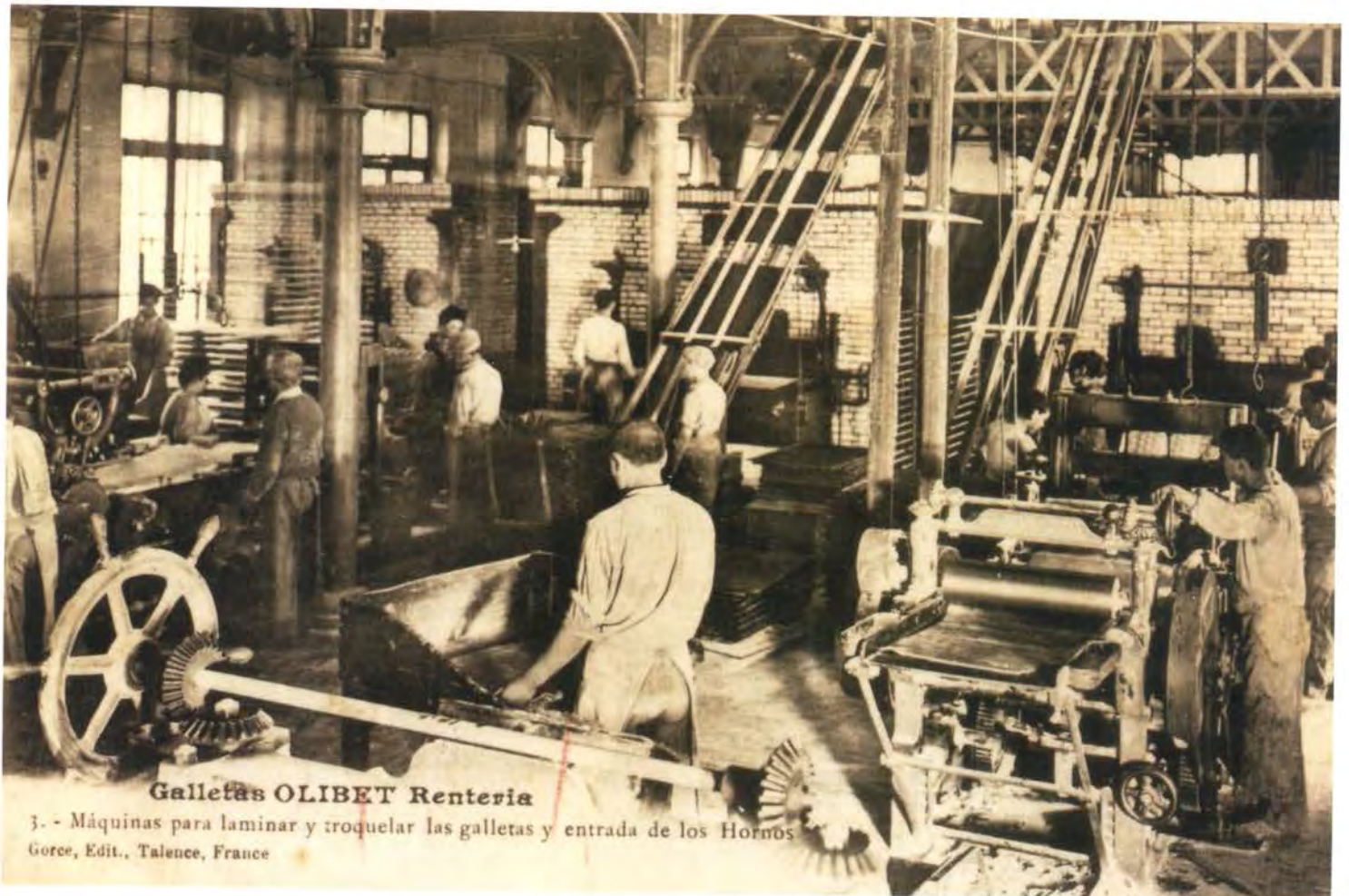
Máquinas para laminar y troquelar las galletas y entrada de los Hornos en la fábrica de "Olibet" a principios de siglo.
